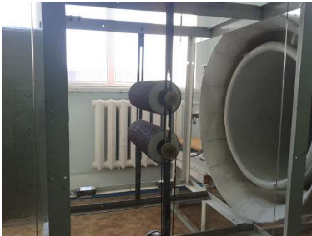
1.2 сурет – Бір біріне параллел орналасқан айналмалы қозғалыстағы кедір-бұдыр бетті цилиндрлер бекітілген аэродинамикалық құбырдың жұмыстық бөлігінің бейне суреті
