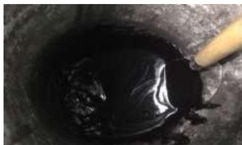
1 сурет. Көмір қалдықтарынан алынған сулы – көмірлі отынның сынама үлгісі
