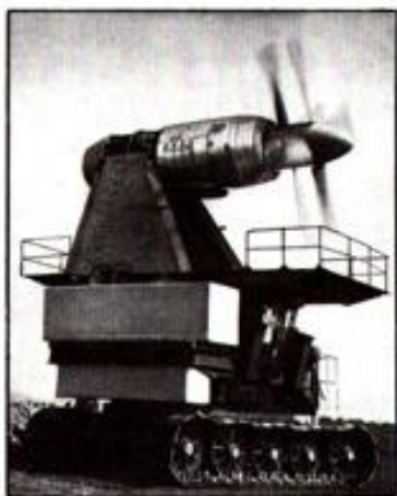
Рис.1. Вентиляционные установки, применяемые в карьерах: а) – на базе винта самолета Ил-18; б) – полив уступов с помощью дождевально-вентиляционных установок; в) на базе винта самолета Ту-114; г) на базе турбины реактивного самолета. [2:17]
