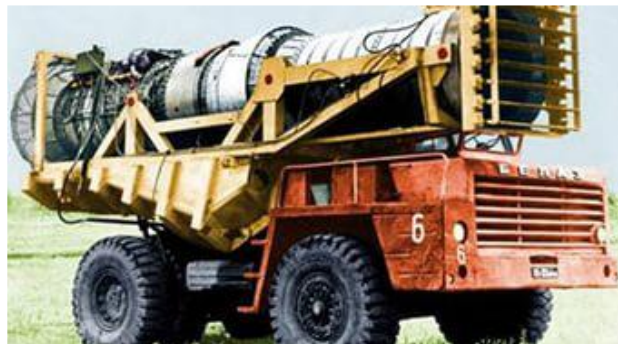
Рис.1. Вентиляционные установки, применяемые в карьерах: а) – на базе винта самолета Ил-18; б) – полив уступов с помощью дождевально-вентиляционных установок; в) на базе винта самолета Ту-114; г) на базе турбины реактивного самолета. [2:17]
