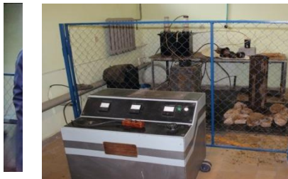
Сурет 1 - Зертханалық электрогидравликалық қондырғы
